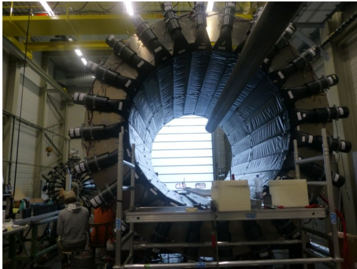
COMPASSで実際に使われている検出器の写真
